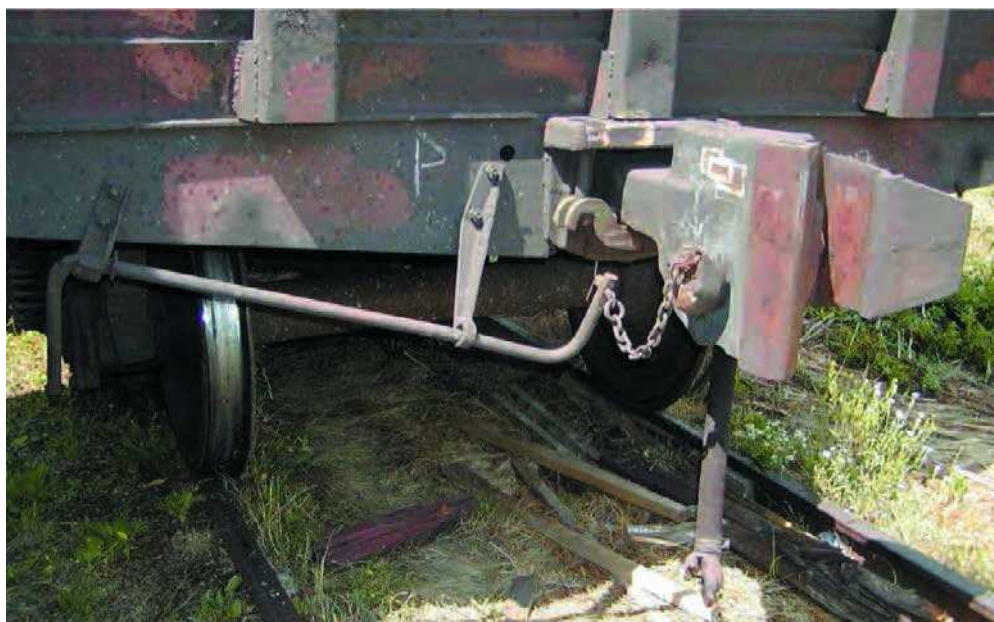
شکل ۳-۲۲) نمایی از یک واگن مجهز به کوپلینگ SA3
