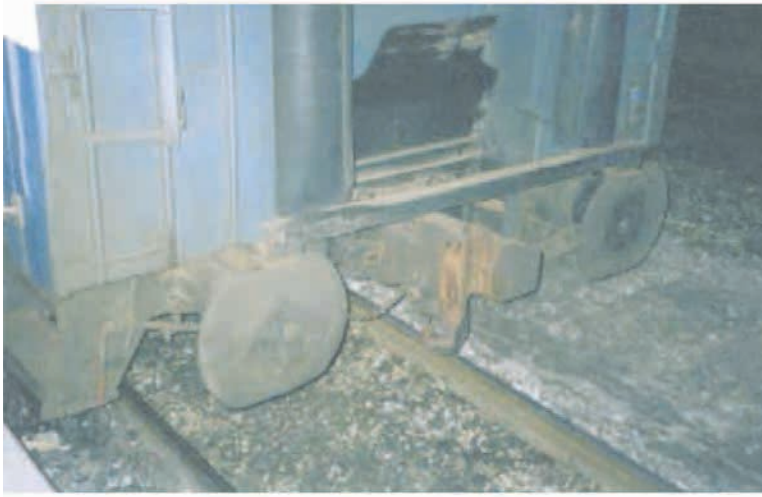
شکل ۱-۴) تامپون که در دو طرف واگن قرار گرفته است
