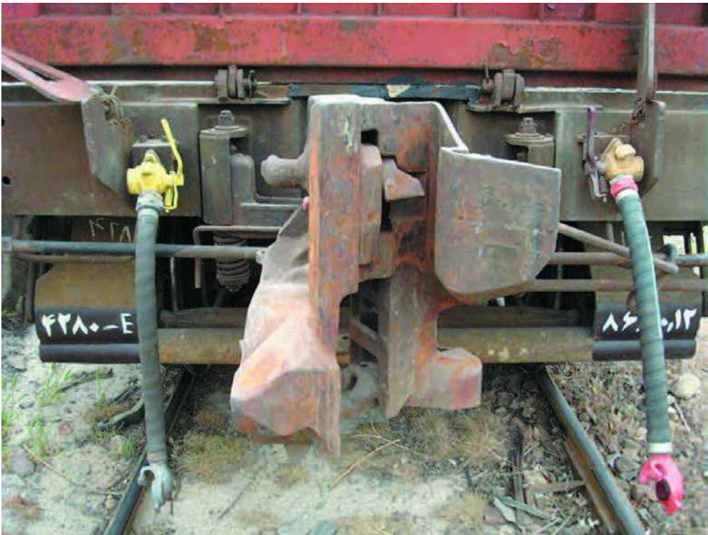
شکل ۳-۱۵) نمای ظاهری یک قلاب یونی کوپلر
